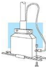
步骤 3：用螺丝将环形接线端子固定
