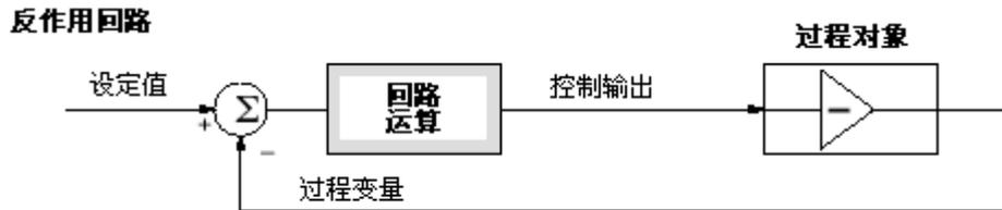
**知道一个特定回路是正作用还是反作用是十分关键的！**在流量控制中，阀位控制回路的组态和连线反作用与正作用一样容易。要弄清楚回路作用的最简单的方法就是在手动方式下运行回路，此时必须手动产生控制输出值。观察 PV 随着控制输出的增加是上升了还是下降了。
