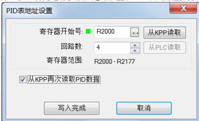
图示：设 R2000 为 PID 参数区起始地址，PID 回路数量为 4 个，点击“写入完成”完成第一步设定。
