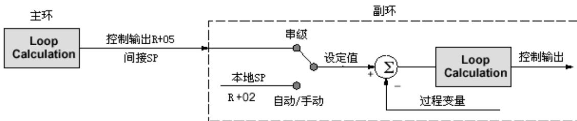
记住，如果副环脱离了串级方式，那么主环自动变成手动方式。
