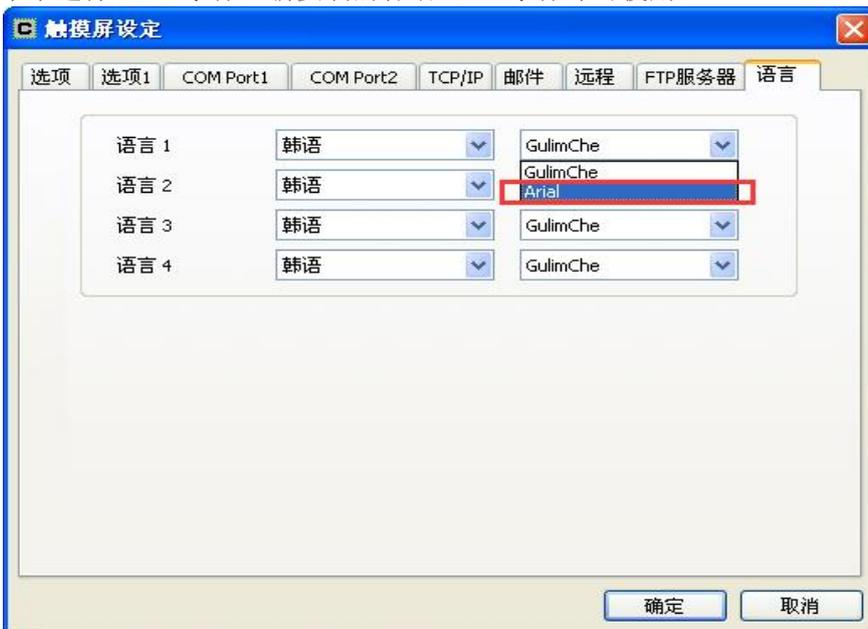
注意:更换字体后，已经配置到画面上的部分部品内显示文字的大小、间隔可能会发生变化，请自行检查调整。
