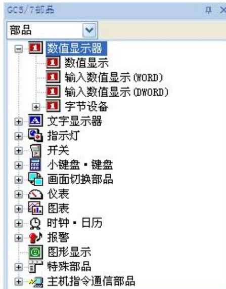
即使没有合适的部品，可以在画面放置功能类似的部品，并对此部品进行自定义，创建所需部品。
