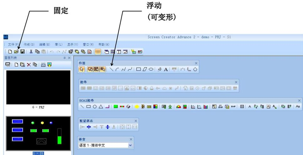
所有的工具栏既可以是固定的(连接到主框架的边缘),也可以是浮动的(处于无模式浮动状态)。可以用鼠标按住工具栏按钮以外的部分并拖动到合适的位置,可以切换到任意喜欢的位置。
