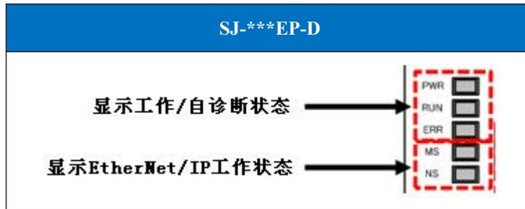
以下是EtherNet/IP操作状态显示LED的显示状态列表。
