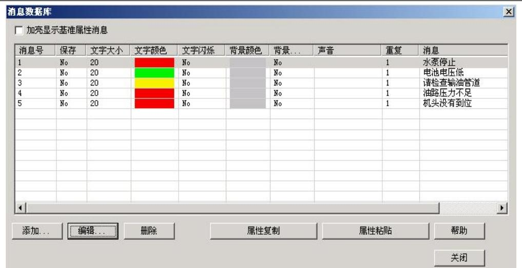
**关于消息号：**消息号是用于连接[看板文字]部品和消息数据库的桥梁。[看板文字]部品中设置的变量（本例子中为：信息号）中的值即为要显示消息的消息号。当指定的消息没有定义时，[看板文字]部品将显示空白。
