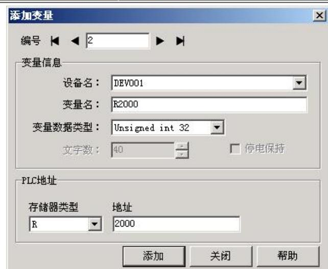
点击[添加变量]窗口的[添加]按键，系统就把R2000 变量添加到[变量名数据库一览]表中，同时[添加变量]窗口的 编号自动加1，等待你进行下一个变量的输入。如果，没有新的变量要输入，点击[关闭]按键关闭[添加变量]窗口，结束变量添加输入。
