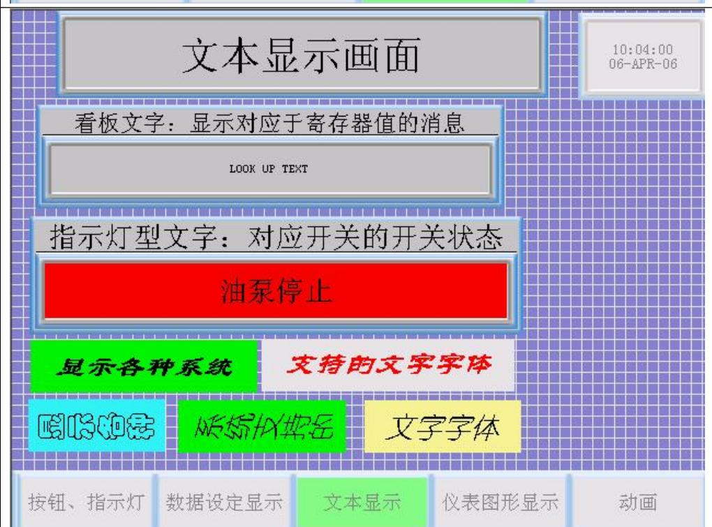
至此，完成了画面 3 的制作，你可以用模拟运行来看一下该画面的运行效果。用画面切换键切换到该画面；改变“信息号”变量的值，看 [看板文字] 部品显示的信息是否正确；改变“开关 1”变量的值，看 [指示灯] 型部品显示的内容是否正确。
