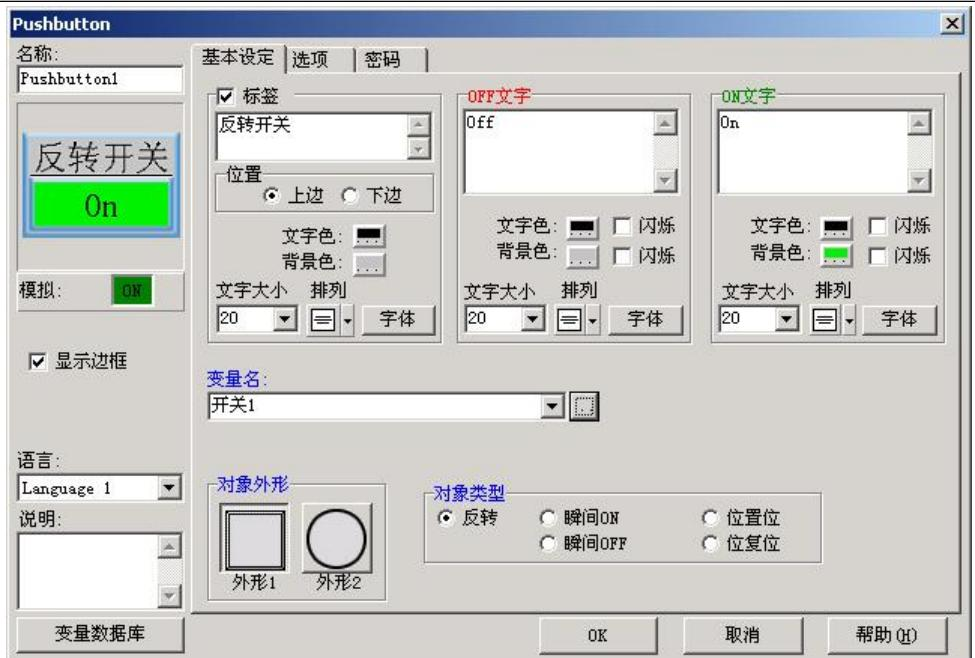
点击OK，关闭属性窗口，拖动该部品到画面上合适的位置，该部品即制作完成，显示如右图。
