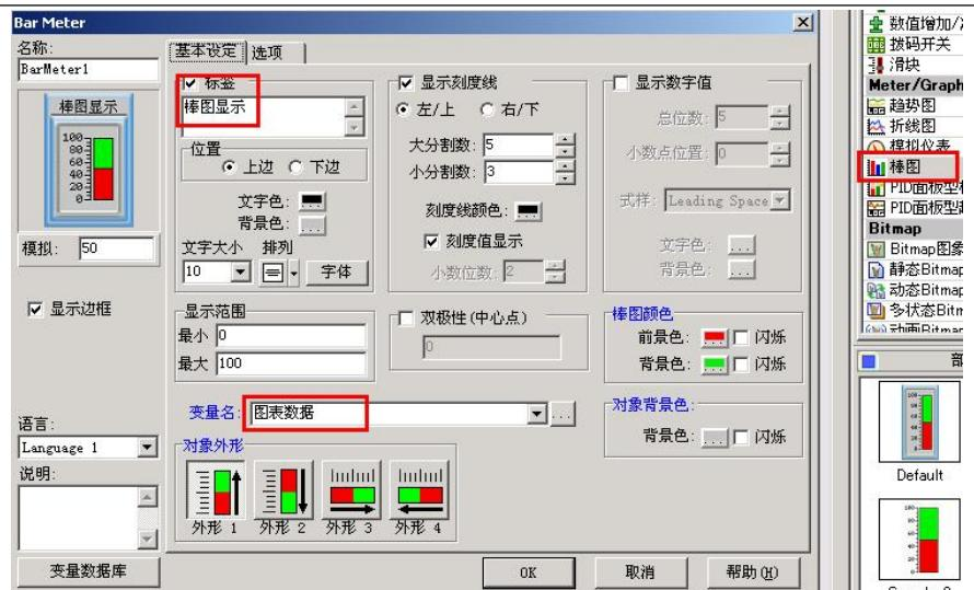
点击 OK 键，关闭[棒图]部品属性窗口，改变[棒图]部品大小并拖动该部品到画面上合适的位置，该部品即制作完成，显示如右图。
