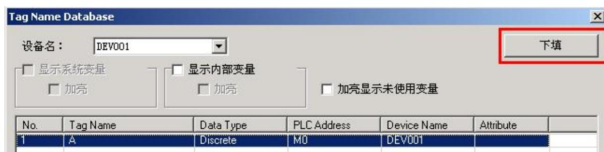
上面的例子中选中（用鼠标点击需要选择行）变量 A 后，连续按[下填]按键 5 下，则系统自动生成 5 个变量如下：
