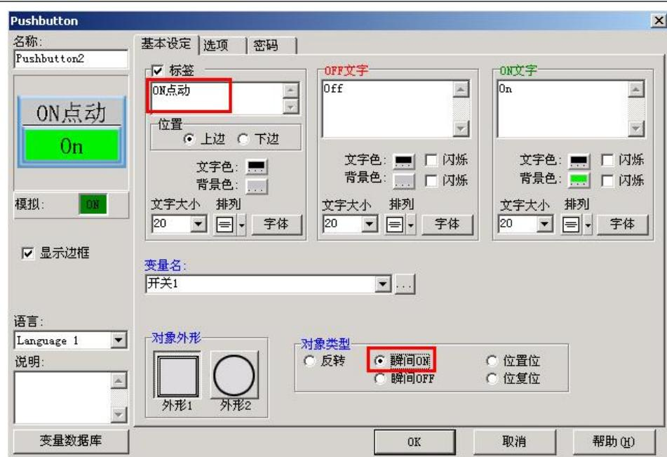
点击 OK，关闭其属性窗口。拖动该部件到画面上相应的位置，即完成“ON 点动”按钮部件的制作。
