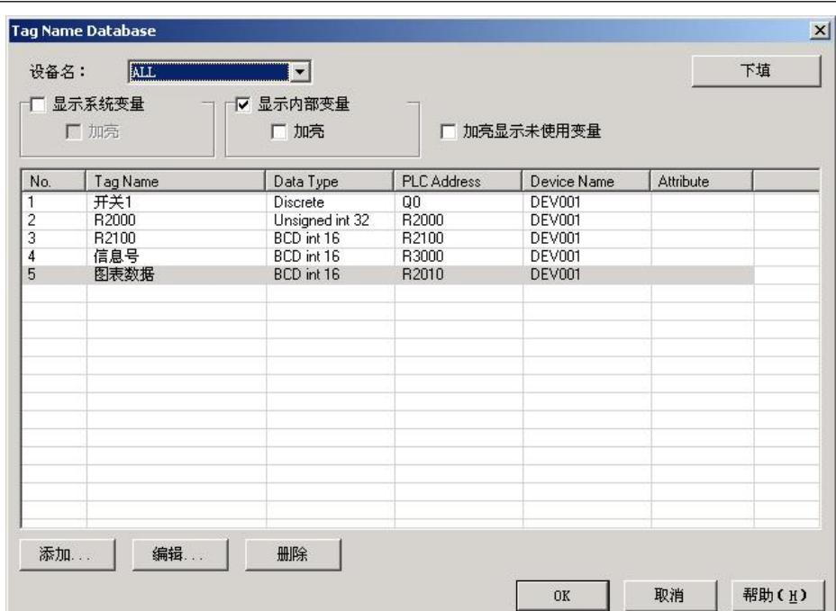
点击[OK]键，可以保留所有添加，关闭[变量名数据库一览]窗口。如果需要修改某个变量的内容，可以选中该变量行，点击[编辑]按键，打开[变量编辑]窗口，对该变量定义进行编辑、修改。
