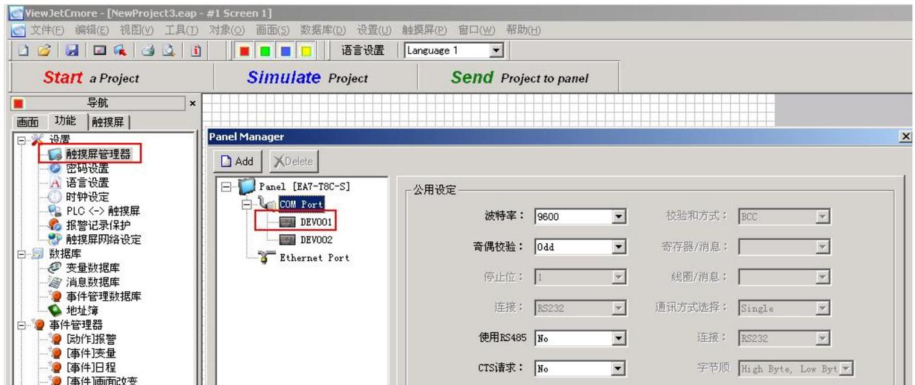
添加好设备后，就可以设置对应于该设备的设备变量。每个设备的设备变量需要分别设置。如下图所示例子中，连接了 2 台 PLC，每台 PLC 都有 Tag1、Tag2、Tag3 三个变量，则该 6 个变量需要分别定义，而且不能同名。定义时要注意使用不同的设备名称。
