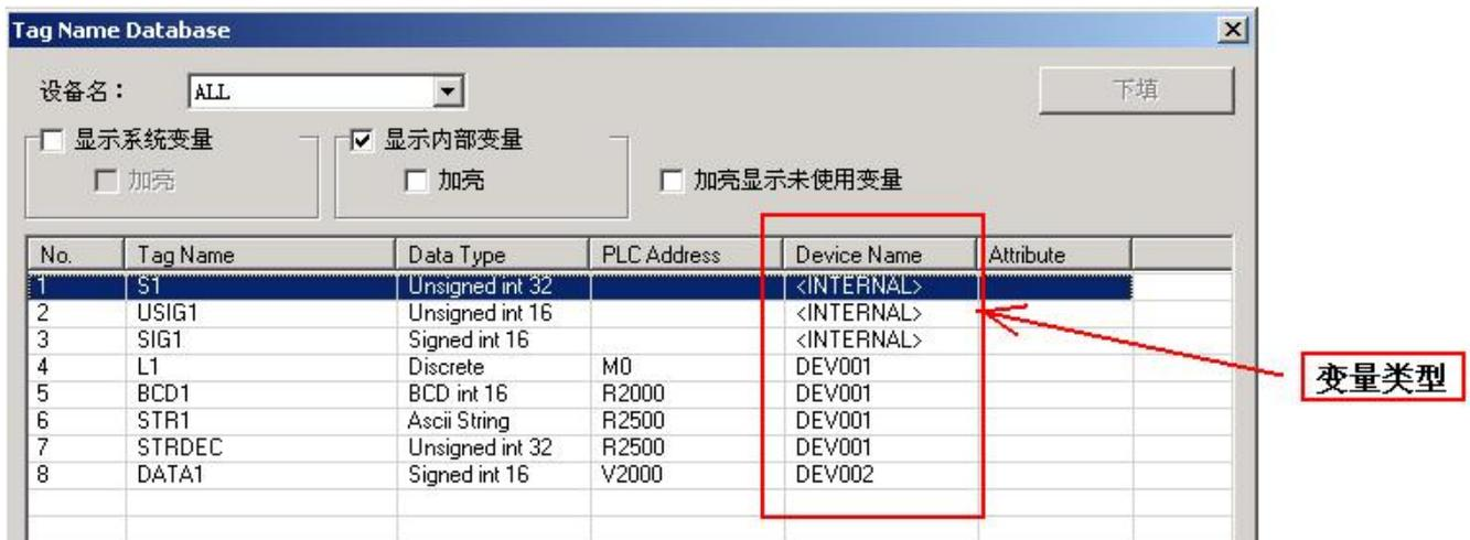
内部变量不占用 PLC 存储器空间，在每个工程中都可以使用内部变量。内部变量的定义方式与设备变量是一样的，只是其设备名选择为内部变量。有效使用好内部变量，可以使得控制程序更简洁、快速。例如，使用内部变量来控制动画动作；利用内部变量来作为按钮、数据输入的互锁条件；利用内部变量作为配方的数据源等等。
