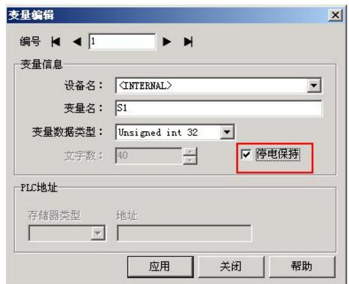
**注意：**内部变量的停电保持功能是通过电池来实现的，请随时注意触摸屏电池的使用情况，如果电池电压不足，请尽快更换电池。以保证停电保持的数据不丢失。
