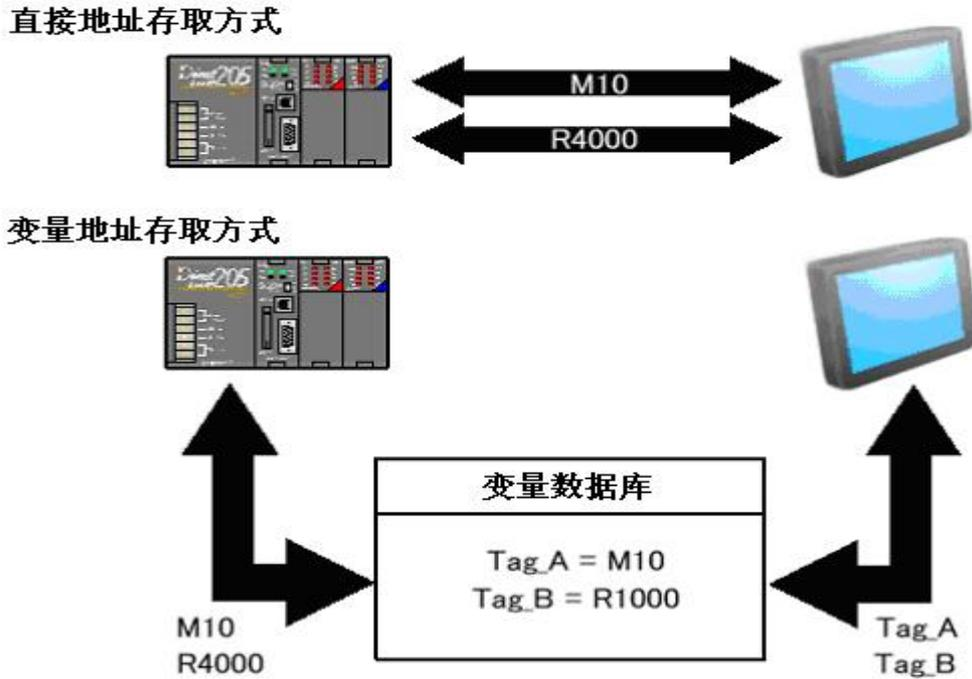
一、从变量的数据类型来分，主要分开关量、寄存器量、字符串变量三种。定义变量时必须指定其数据类型。
