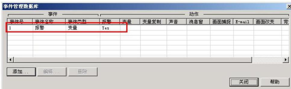
以上就完成了该报警事件的设置工作。把该工程文件传送到ViewJetCmore 触摸屏中，每次“开关1”变量为ON，在触摸屏下方会显示相应的报警信息。
