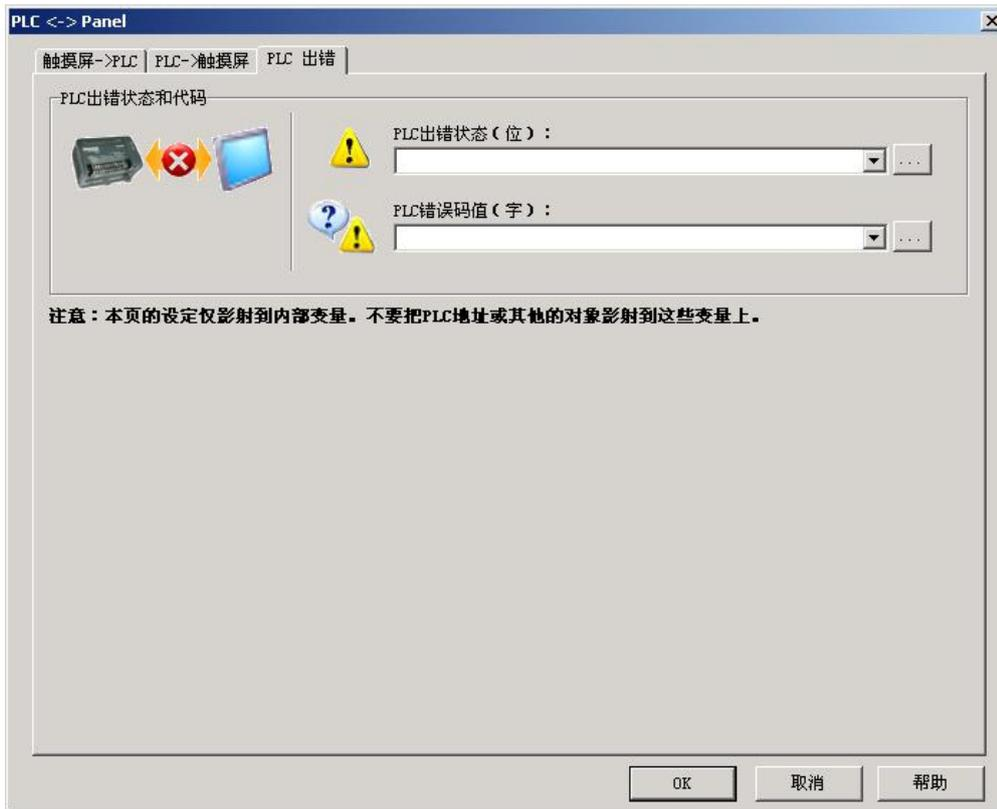
如上图所示，当触摸屏与 PLC 通讯过程中发生错误时，将在触摸屏上闪烁显示出相应的通讯错误信息，其显示周期为：显示错误信息 3 秒—>停止显示 1 秒—>显示错误信息 3 秒.....，如此循环显示。同时将给出该页 2 个 PLC 出错状态信息。其含义分别说明如下。注意该页的变量不能关联到设备对象上，而只能使用 ViewJetCmore 的内部变量。
