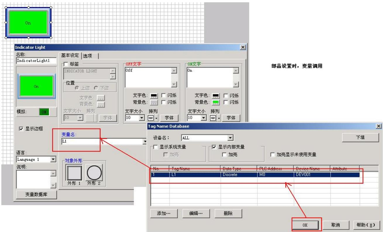
这与以前的在画面部品上直接定义 PLC 地址的方式有所不同。我们把在画面部品上直接定义 PLC 地址的方式叫直接地址存取方式；而把通过变量定义的方式叫做变量地址存取方式。2 者的差别如下图所示。
