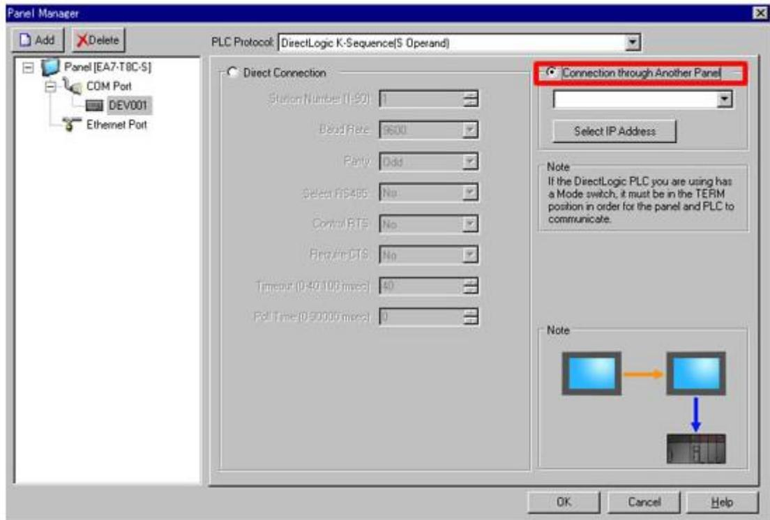
Step2: 单击“Select IP Address”,则显示“以太网连接设定”对话框，指定要通过连接的触摸屏的IP地址。
