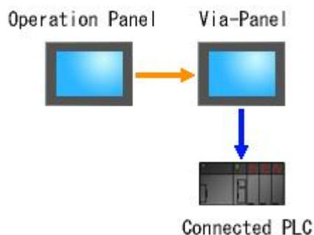
**Step1:** 通过另一台触摸屏连接必须由触摸屏管理器中选择“Connection through Another Panel”来设定。
