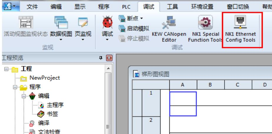
点击上面画面中的 [NK1 Ethernet Config Tools]，就会打开 NK1 以太网专用设置窗口，用于设置 NK1 以太网扩展通信参数，下面为 UDP 模式无协议通信的参数设置画面例。
