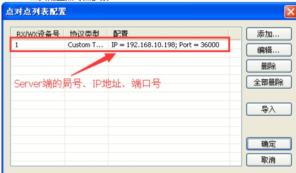
4、通信例程[NK1(TCP Client)程序(500ms 接收一次，1000ms 发送一次数据)]
