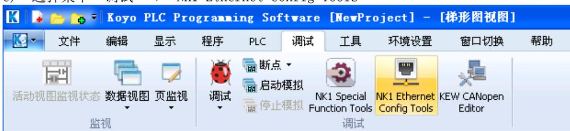
备注：NK1 以太网通信口的节点 ID 号、IP 地址、子网掩码、网关以及 SMTP 邮件发送参数等网络参数不用本工具软件设置，而用其他方式设置，具体设置方法请参见《NK1 用户手册》（4.6.3 NK1 本体以太网通信端口通信参数设置）章节有关内容。
