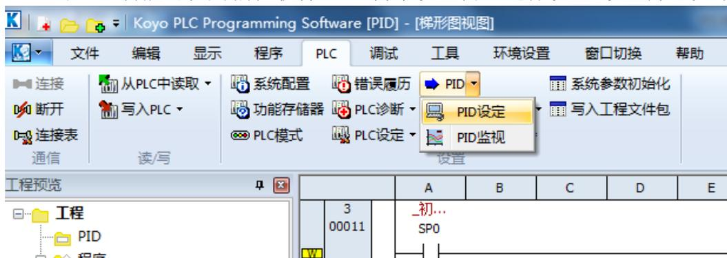
在 KPP 软件界面的主菜单的 PLC 菜单下选取 PID 功能菜单进行 PID 设定。
