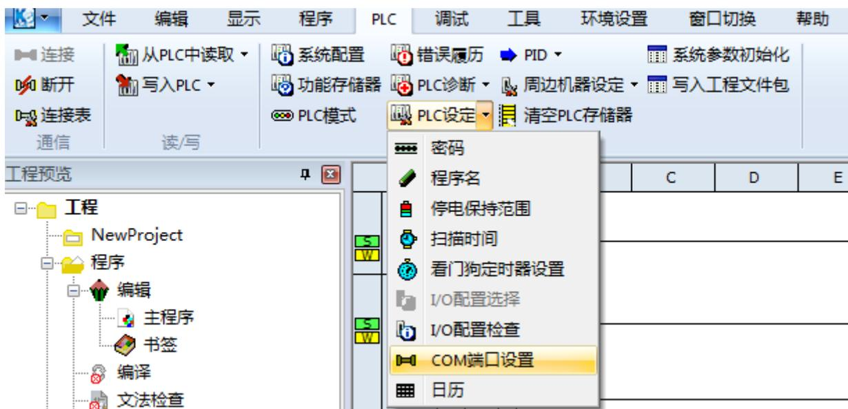
对 Port1 通讯端口（RS485）进行设置，设置完成后点击功能按钮将参数写入 PLC。
