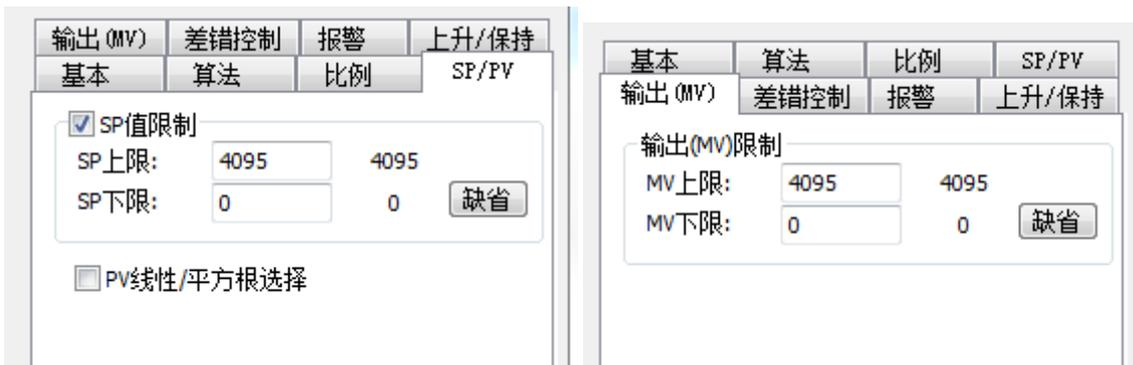
由于 NK1 的模拟量模块的输入输出数据精度为 12bit，所以在《SP/PV》页面中设置 SP 上下限为 4095 与 0，在《输出 MV》页面设置 MV 上下限为 4095 与 0。在本程序中，PID 设置中的其他未加说明的功能设置页面都采用默认设置即可。
