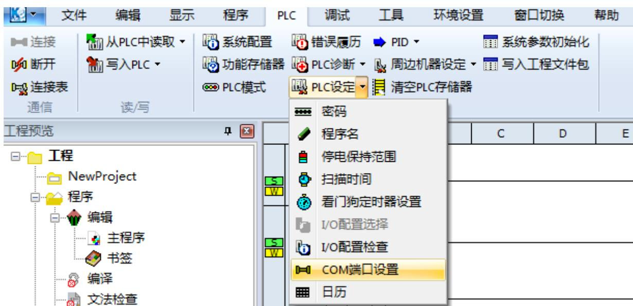
对 Port3 通讯端口（以太网口）进行设置，一般都需要手动进行 IP 分配，设置完成后点击功能按钮将参数写入 PLC。
