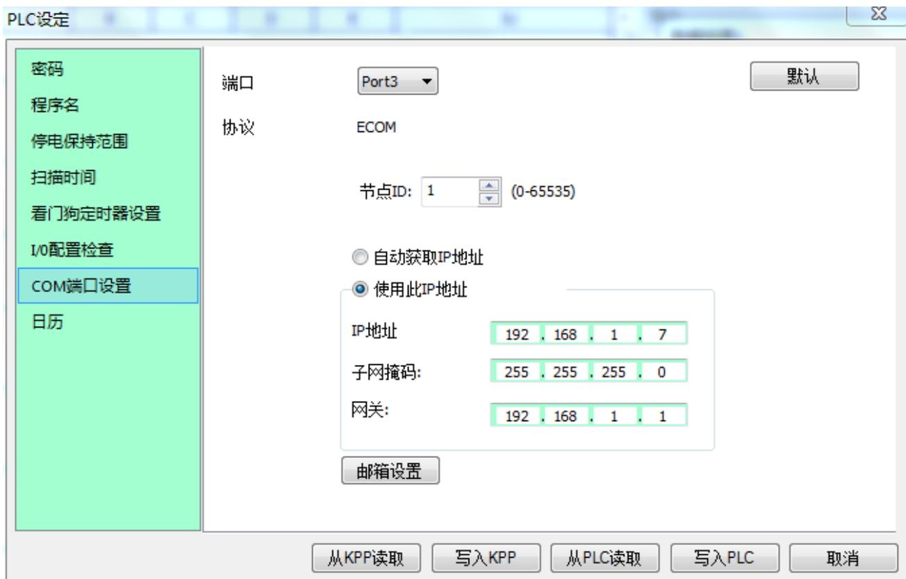
通过 KewNetEdit 软件对通讯口进行二次设置，连接好网线后通过 KewNetEdit 软件搜索到 NK1 PLC。
