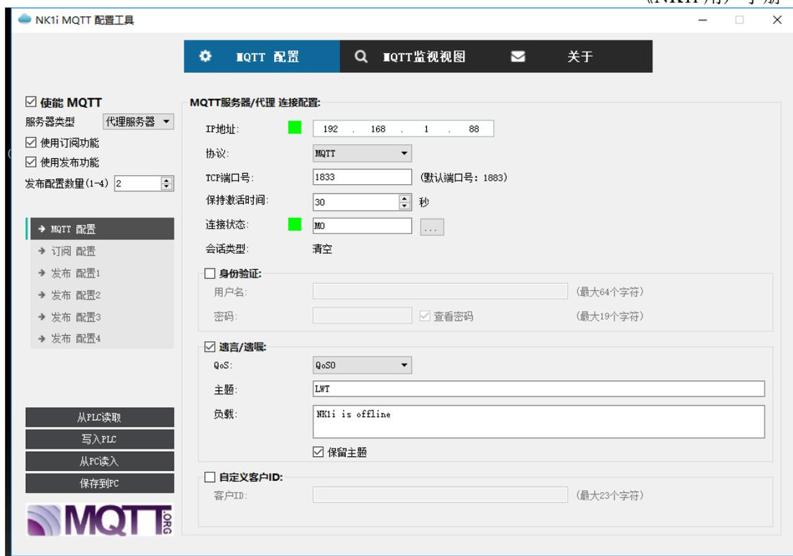
通用服务器的 MQTT 配置图例。
