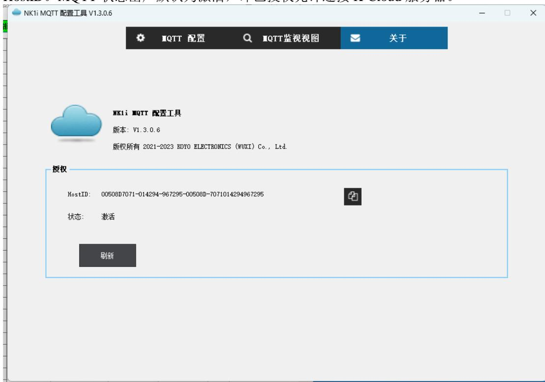
3. 用于配置 MQTT 的 IP 地址、端口号、以及组织机构代码等，请联系客服获取。如果 NK1i 连接服务器成功，连接状态 M70 将置 1，如下图所示。
