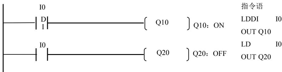
功能存储器的内容没变化，在此扫描中，输出 Q10 为 ON，输出 Q20 没有 ON。
