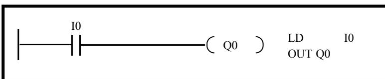
如左图那样的程序，对 I0, Q0 进行 Override 设定，输入、输出状态如下面的时序图所示
