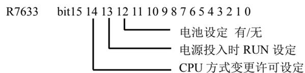
ON: 通讯连接 PLC 可以改变 CPU 动作方式
