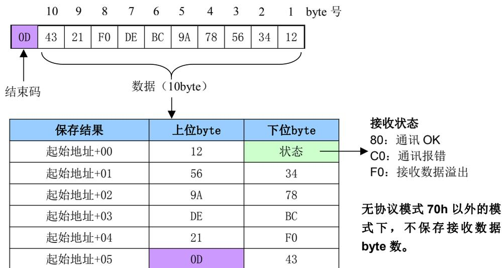
**F: 通用通讯端口 2 RTS ON/OFF 延迟、协议、通讯超时设定**
