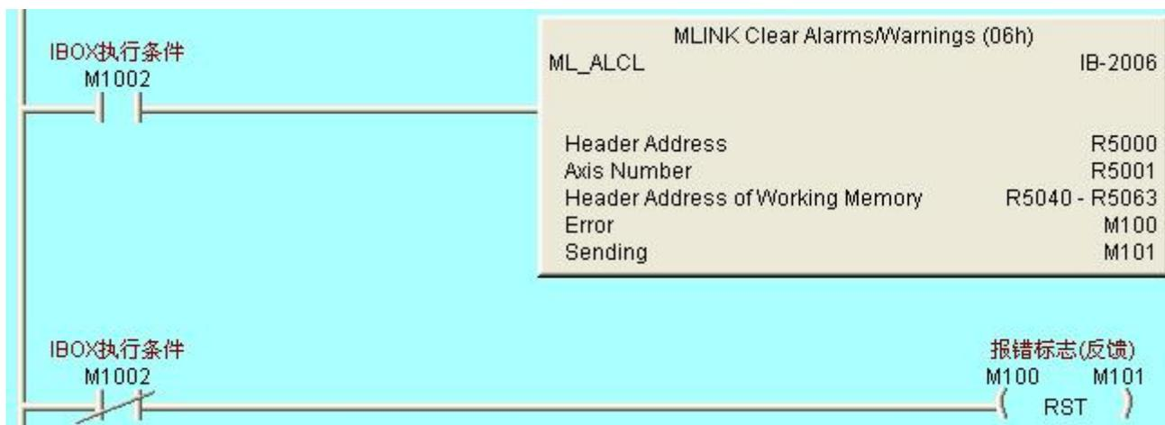
执行条件 M1002 置 ON 时，ML\_ALRD 命令读取寄存器 R5001 内存放的轴编号，并清除轴编号对应的伺服控制器异常/警告状态，然后将反馈数据存放于以寄存器 R5000 内数据为起始地址的寄存器段
