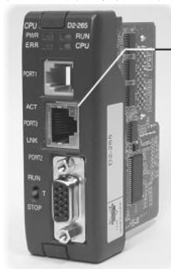
通讯口 3：以太网 /FL-net 通讯的 RJ-45 接 口
