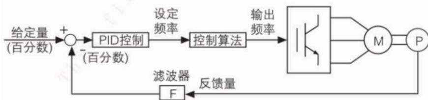
图4-23 过程PID原理框图
